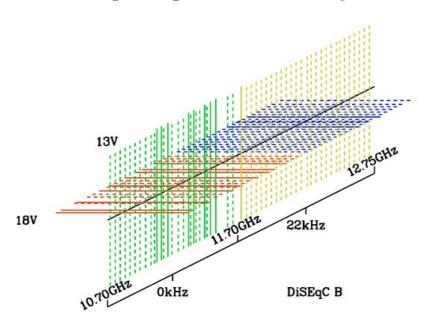
bereich. Gleichzeitig ist der Satellit "Astra" mit "DiSEqC A" und der Satellit "Eutelsat" mit "DiSEqC B" gekennzeichnet und auf beiden Satelliten sind die analog abstrahlenden Sender (Transponder) durchgezogen und die digital abstrahlenden Sender gestrichelt dargestellt (Stand 2001). Selbst im Frequenzbereich, der ursprünglich der analogen Abstrahlung vorbehalten war, tummeln sich mehr und mehr digital abstrahlende Sender. Ab dem Jahr 2010 (ca.) soll es nur noch digitales Fernsehen geben.
