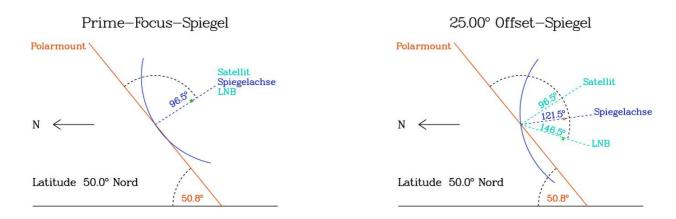
gemeinsamen Achse liegen. Die Empfangseinheit "schielt" in vertikaler Richtung durch den Spiegel. Es gibt also keine Abschattung durch die Empfangseinheit und dadurch, daß der Spiegel insgesamt senkrechter steht, rutscht der in den Spiegel gefallene Schnee sofort wieder aus dem Spiegel heraus und legt sich nicht signal-dämpfend auf die Spiegeloberfläche. In unseren Breiten ein Vorteil. Es kann im Winter auf eine Spiegelheizung verzichtet werden.
