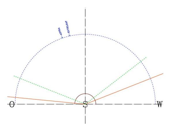
Die vorstehende Abbildung zeigt auch, daß diese beiden für den deutschen interessanten beieinander Sprachraum Satelliten eng Computerprogramme, die nach Eingabe der eigenen Position und der Positionen der gewünschten Satelliten, die Daten zum Ausrichten der Satelliten-Empfangs-Anlage erstellen, belegen das wie nachstehende Tabelle zeigt.
