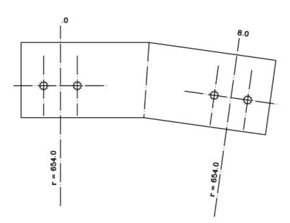
Schüssel mit einem LNB-Abstand von 654 mm. Dieser LNB-Träger (scherzhaft nannte ich ihn "Schieleisen") wurde anschließend verzinkt und unter den zentralen LNB geschraubt. Dann konnte er bequem den "schielenden" LNB tragen. Die Differenz der Elevation, der Erhöhung, der Satelliten "Astra" und
