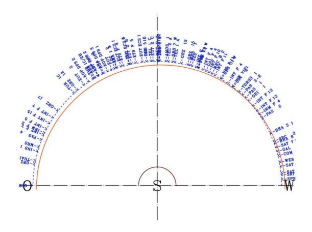
deutlich, daß bei einer Verschiebung des Schwenkkreises (rot) zum Satellitenkreis (blau) nur wenige Satelliten genau getroffen werden.
